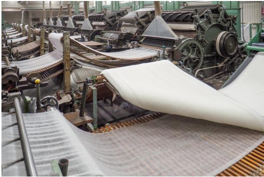
写真5 第一工場のカード機
